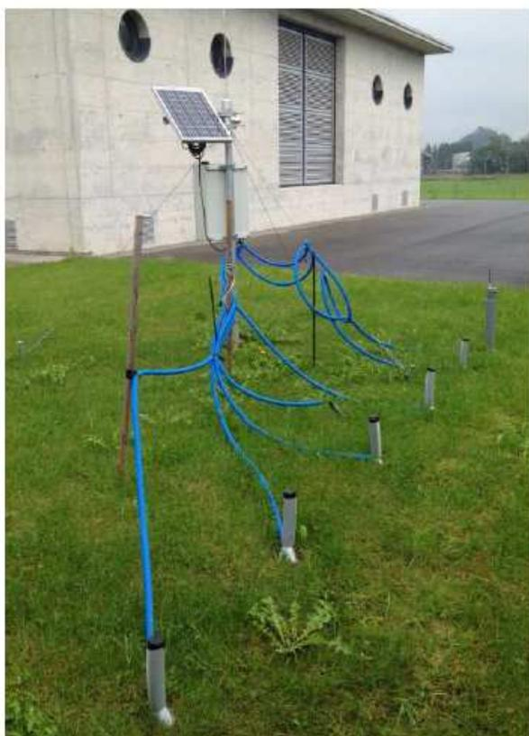
**Figura 1:** Stazione di misura a Stabio, composta di sei tensiometri collegati a un sistema centrale automatizzato per la raccolta dei dati.
