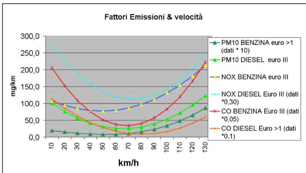
**Grafico 1:** per le PM10 e gli ossidi d'azoto dei veicoli diesel e il monossido di carbonio, il fattore di emissione minore si registra intorno ai 70–80 km/h. Per tutti i tipi di veicolo e di inquinanti, a partire dagli 80 km/h le emissioni specifiche aumentano.
