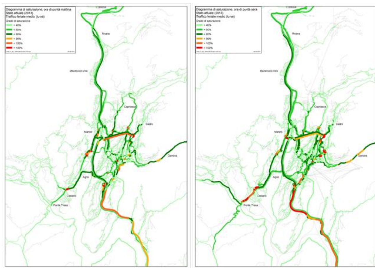
Figura 52 - Diagramma di saturazione OPM/OPS - situazione 2013 (Fonte: Modello di traffico, elaborazione Brugnoli e Gottardi SA)
