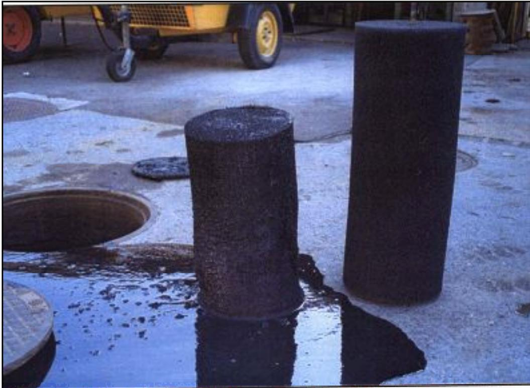
**figura 16:** filtro a coalescenza esausto (a sinistra) intriso d'idrocarburi e filtro nuovo (a destra)
