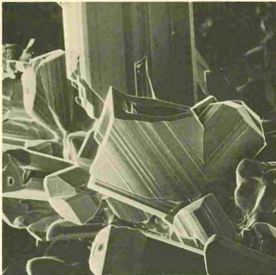
Cristalli di zolfo di biemate fotografati con il microscopio a scansione elettronica
