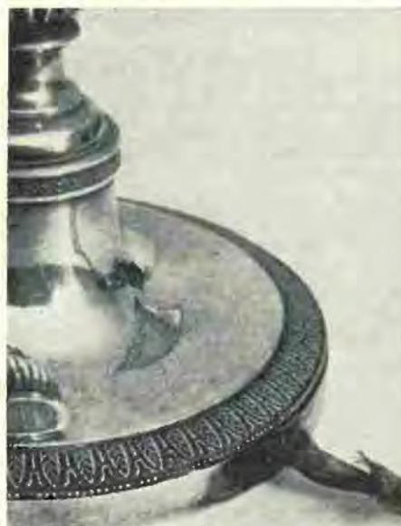
Fig. 6 — Lampada metallica da tavolino. Causa il cordone danneggiato la corrente poté passare nella parte metallica della lampada.
