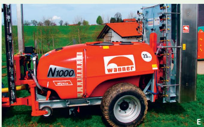
**Irroratrici a flusso d’aria orizzontale orientabile e rilevatore di vegetazione**
