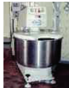
Miscelatore o impastatore con coperchio.
