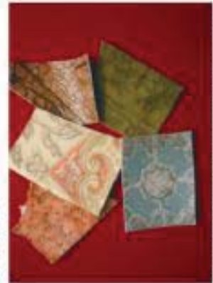
2 I rivestimenti multistrato per pareti ed pavimenti presentano solitamente uno strato portante in PVC contenente amianto in matrice friabile.
