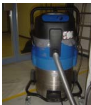
2 Aspiratore industriale con filtro per classe H (amianto)
