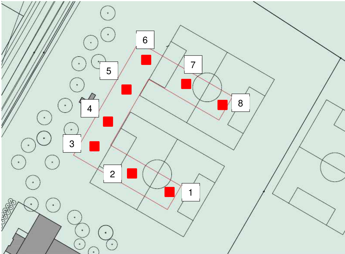
Figura 2. Posizione delle fosse di assaggio eseguite nell'area interessata dalla costruzione. Base: Dati ingegnere progettista.
