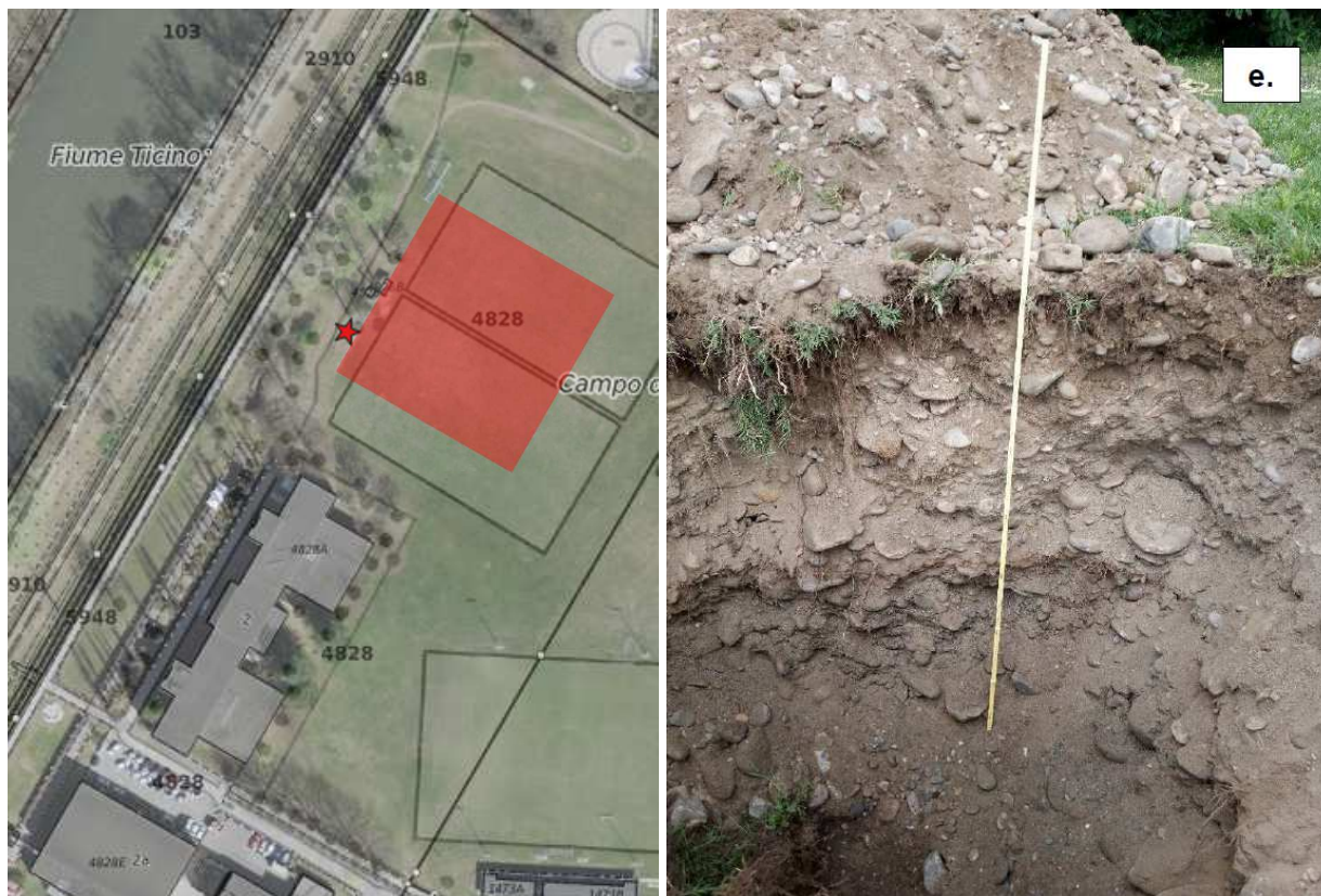
Figura 2: Campagna di 8 sondaggi superficiali a scopo geotecnico (quadrato rosso) e scavo di una trincea per prova di infiltrazione (stella rossa) di 2.3 m di profondità (foto © [6]).
