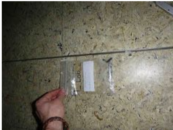
Materiale PCB nr. 1: mastice nei giunti del pavimento - non contiene PCB
