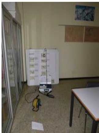
Aula 210 - verifica della presenza di fibre di amianto respirabili nell'aria - nessuna fibra rilevata
