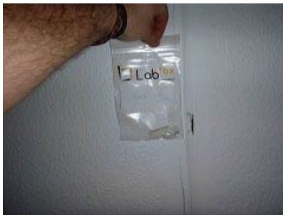
Materiale PCB nr. 3: mastice nei giunti delle pareti - non contiene PCB
