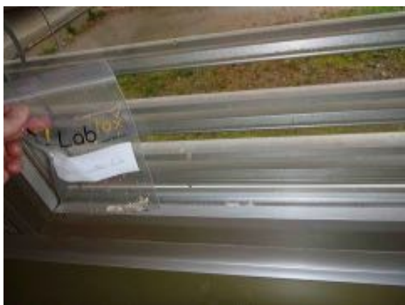
Materiale PCB nr. 4: mastice delle finestre - non contiene PCB
