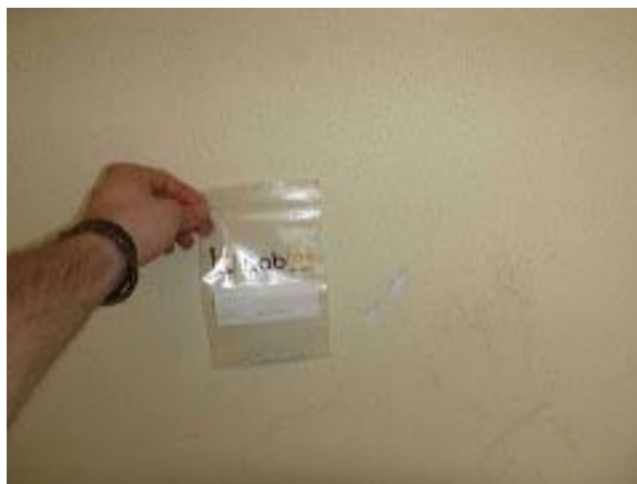
Intero edificio - Materiale 22: intonaco interno - non contiene amianto
