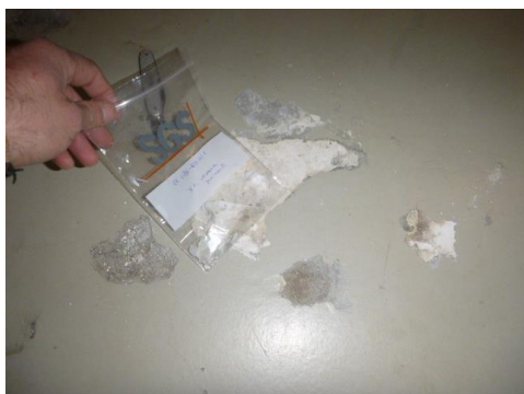
Materiale Pb1: vernice su pavimento in cemento. Prelievo campione X1 per verifica presenza di piombo
