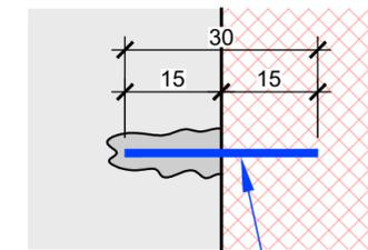
38 Spezzoni d'armatura da fissare con ancorante chimico HILTI-RE 500 V3 o prodotto equivalente L= 30cm Ø= 16 mm
