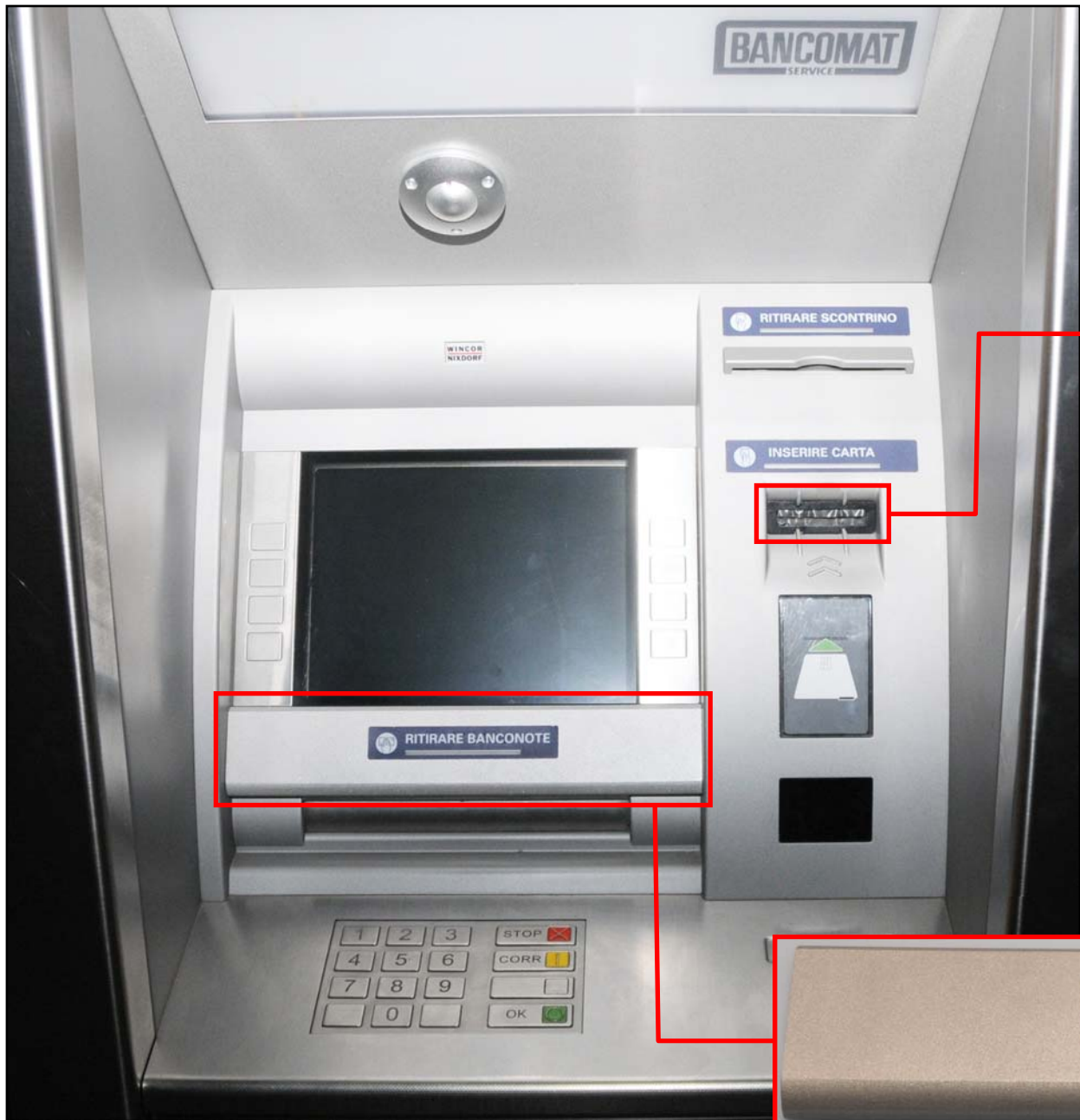
Frontalino con microcamera integrata che filma la tastiera numerica del Bancomat
