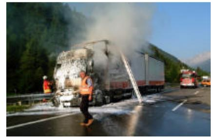
Incendio di un TIR sulla A2 all'altezza di Airolo. Le rampe d'accesso alla galleria del S. Gottardo portano a un surriscaldamento del blocco motore e al rischio d'incendio.
