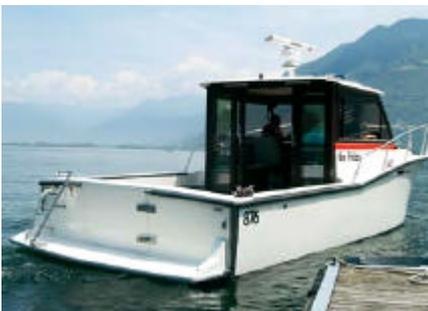
Nel mese di giugno è stato varato, dopo quattro mesi di istrutturazione, il natante della lacuale, messo in esercizio per la prima volta nel 1988. I due nuovi motori gli permettono di raggiungere i 70 km/h. Con 11 metri di lunghezza e un peso di 5 tonnellate, è provvisto di ricetrasmittente con GPS, un sistema ecoscandagli, radar, barra di segnalazione con fari lampeggianti, sirena, fano girevole orientabile e luci di segnalazione.
