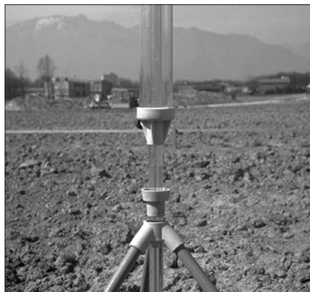
Fig. 45 - Controllo della permeabilità di un riporto esteso in occasione di una campagna sul terreno dell'istituto IATE/EPFL (Al Carcale, 1994) presso Gordola/TI.
