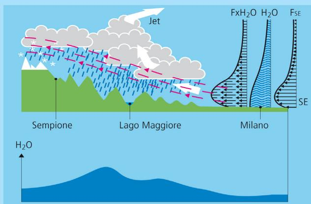
Profilo qualitativo sud-est (SE) – nord-ovest (NO) delle precipitazioni della zona del bacino idrografico del Lago Maggiore. F: profilo del vento (componente SE perpendicolare alle Alpi); H<sub>2</sub>O: profilo del contenuto di acqua; FxH<sub>2</sub>O; combinazione, quale flusso d'acqua diretto verso NO.
