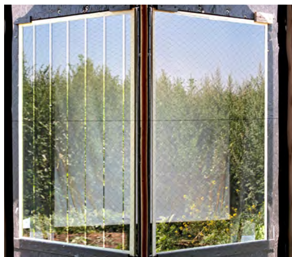
Arnold Glas Ornilux® design lines 5/95: marcatura metallica altamente efficace con classico motivo a strisce (a sinistra lastra di prova, a destra lastra di riferimento).
