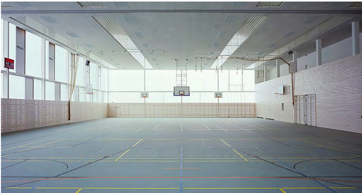
L'involucro della palestra di pallamano di Ingolstadt (Germania) di Fink+Jocher consiste in una costruzione in vetro profilato riempita con isolamento termico traslucido tra i due gusci del profilo in vetro. Ciò garantisce un'illuminazione sufficiente senza ombre fastidiose sul campo di gioco.
