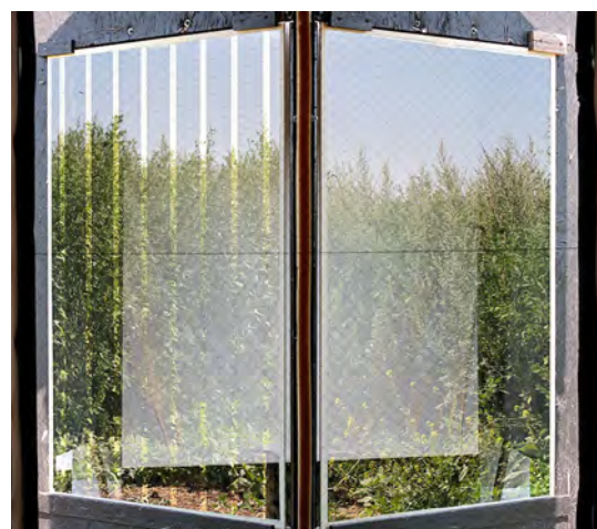
Una marcatura in fase di sviluppo (Fraunhofer ISE) con strisce trasparenti alla posizione 1 si è rivelata molto efficace (a sinistra lastra di prova, a destra lastra di riferimento).
