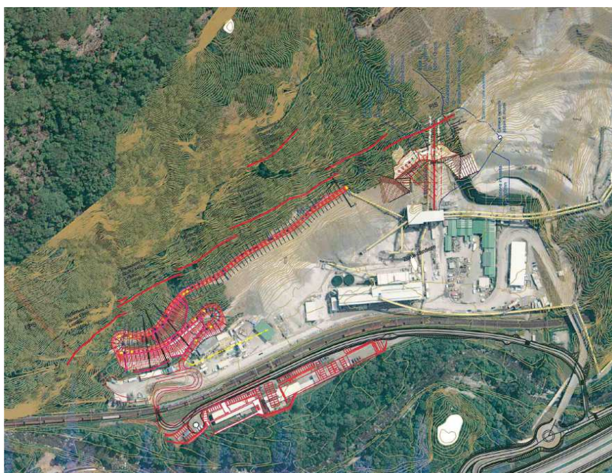
Figura 31: Settore 1 Prati di Regada : disposizione delle reti paramassi realizzate a protezione del cantiere ATG
