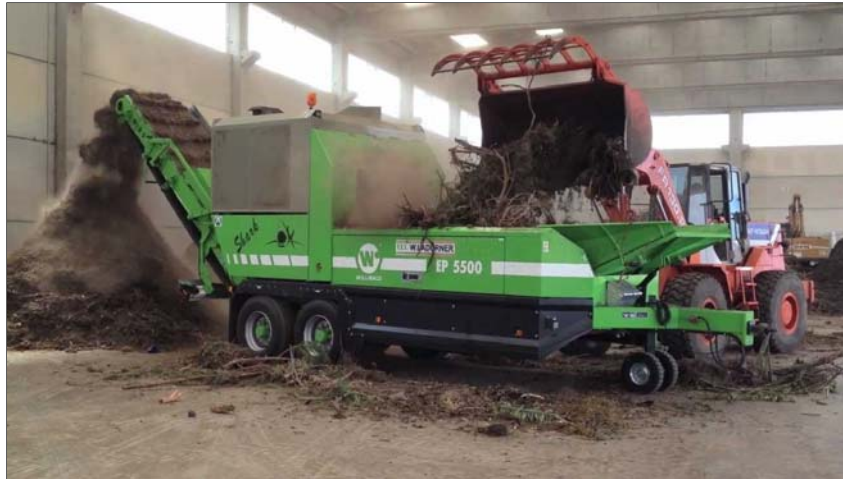
Figura 3.1 – Esempio di trituratore.
