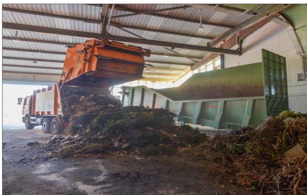
Figura 3.7 – Esempio di compostaggio in capannone chiuso (impianto di Allmig, Kompost und Ökostrom, Baar).
