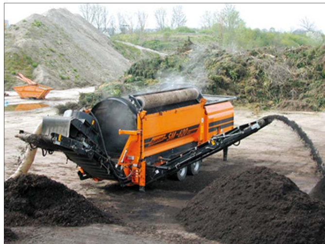
Figura 3.4 - Vaglio a tamburo rotante per raffinazione del compost.
