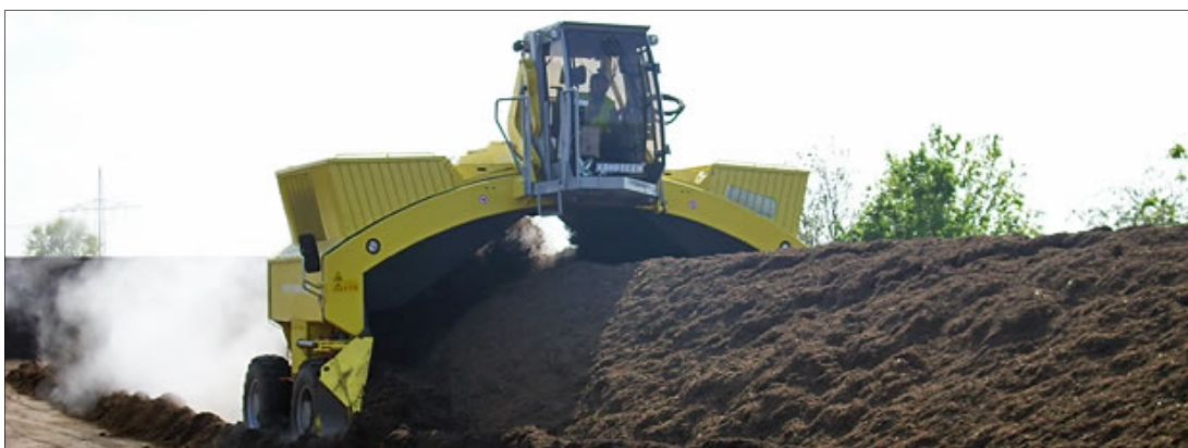
Figura 3.2 – Esempio di una macchina rivolta cumuli.
