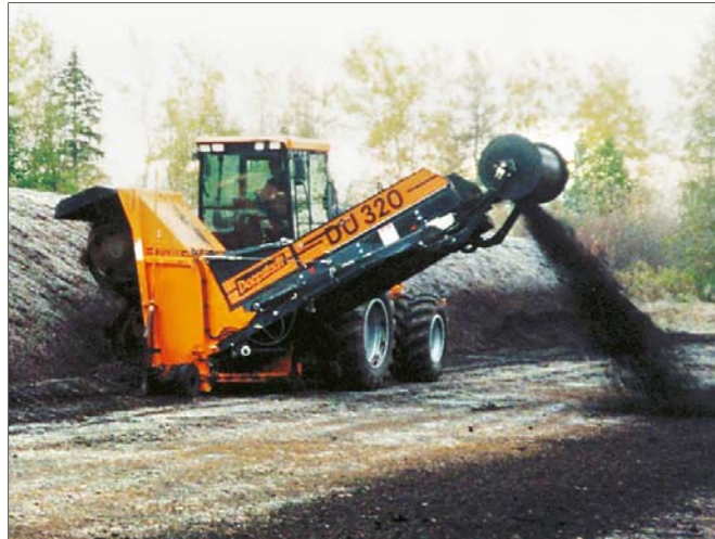
Figura 3.3 – Esempio di una macchina rivolta cumuli.
