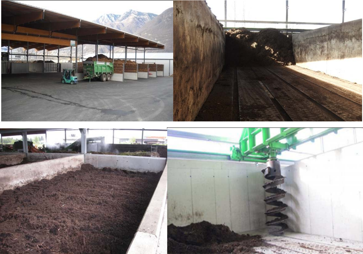
Figura 3.7 – Esempio di un impianto di compostaggio, in box in capannone aperto (Tricomix SA, a Cadenazzo).
