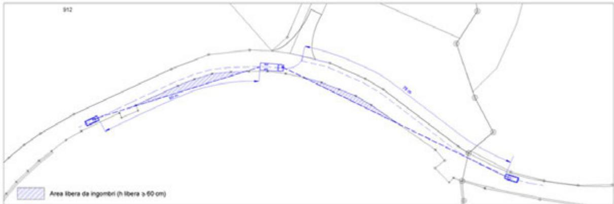
Figura 5.4 – Per garantire il rispetto della norma (per una velocità di 60 km/h) si deve avere un campo di visuale libero nella parte tratteggiata nella figura. Le distanze misurate sarebbero a norma se i veicoli in discesa transitassero a circa 40-45 km/h e in salita circa 30-35 km/h. Per questi motivi si suggerisce un approfondimento, tramite rilievo della velocità effettiva dei veicoli che transitano sull'asse principale e determinare le reali necessità.
