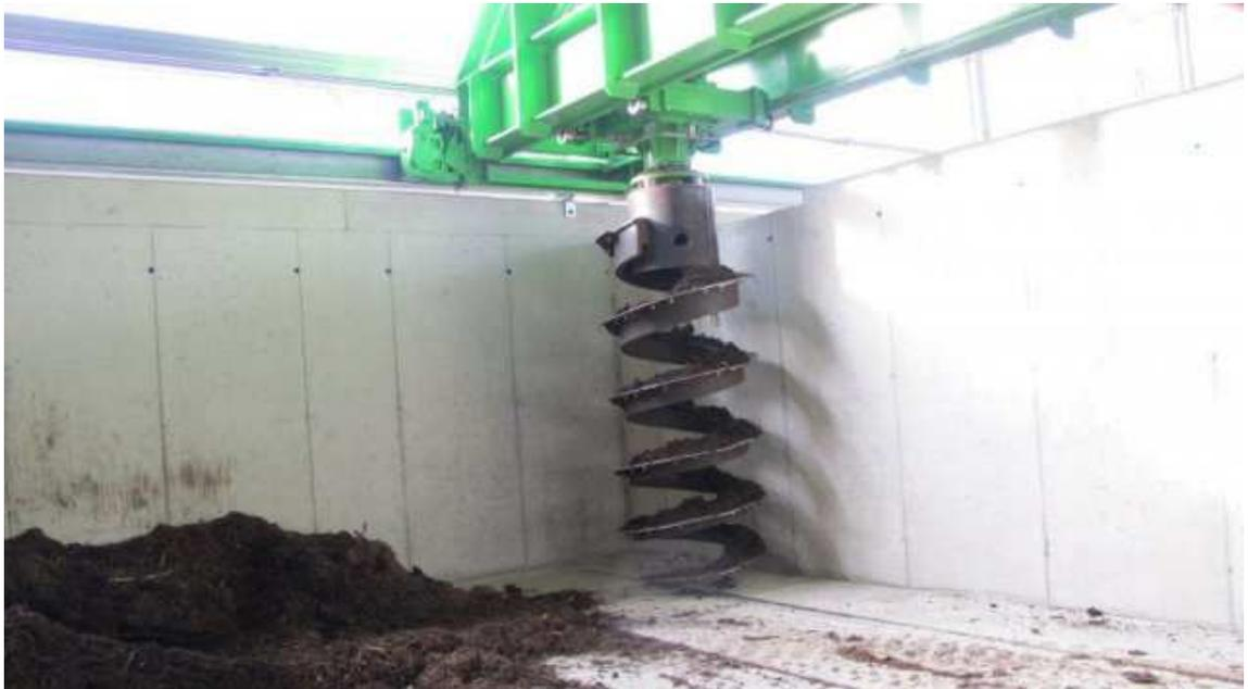
*Figura 7: Sistema per il rivoltamento automatico dei cumuli, impianto di proprietà della Tricomix SA di Cadenazzo, progettato dalla azienda COMPAG AG. fonte: [www.tricomix.ch](http://www.tricomix.ch)*
