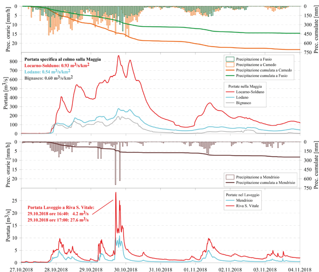
Figura 3 – Idrogrammi di piena della Maggia e del Laveggio. Durante la fase più interna dell'evento si nota la differenza di carattere delle precipitazioni (intensità minore ma accumuli complessivi maggiori nel Sopraceneri, accumuli inferiori ma intensità localmente elevate, a carattere temporalesco, nel Sottoceneri).
