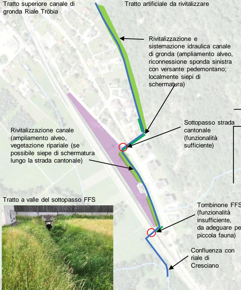
Rivitalizzazione e sistemazione idraulica canale di gronda (ampliamento alveo, riconnessione sponda sinistra con versante pedemontano; localmente siepi di schermatura)
