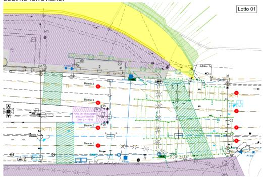
Di seguito la rappresentazione della fase dopo la posa dell'ultimo ponte provvisorio FFS, in cui si identifica lo stato finale dei lavori del presente appalto 0241.308-1 (Lotto 01) con eseguiti tutti i micropali della zona centrale, operata la prima tappa di scavo nel sedime ferroviario ed ultimata la posa dei 4x ponti ferroviari provvisori:
