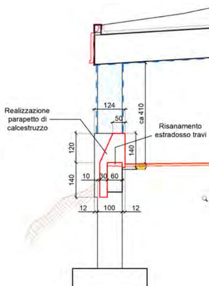
Sezione tipo parapetto parte esistente
