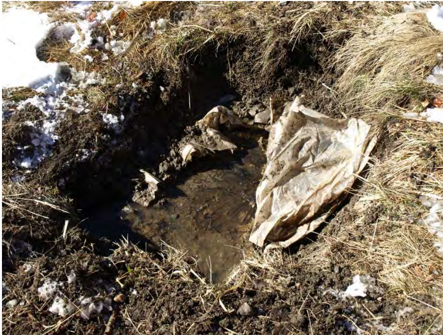
78. Sondaggio n.1, stratigrafia: carta catramata, lana di roccia, plastica (rotta)
