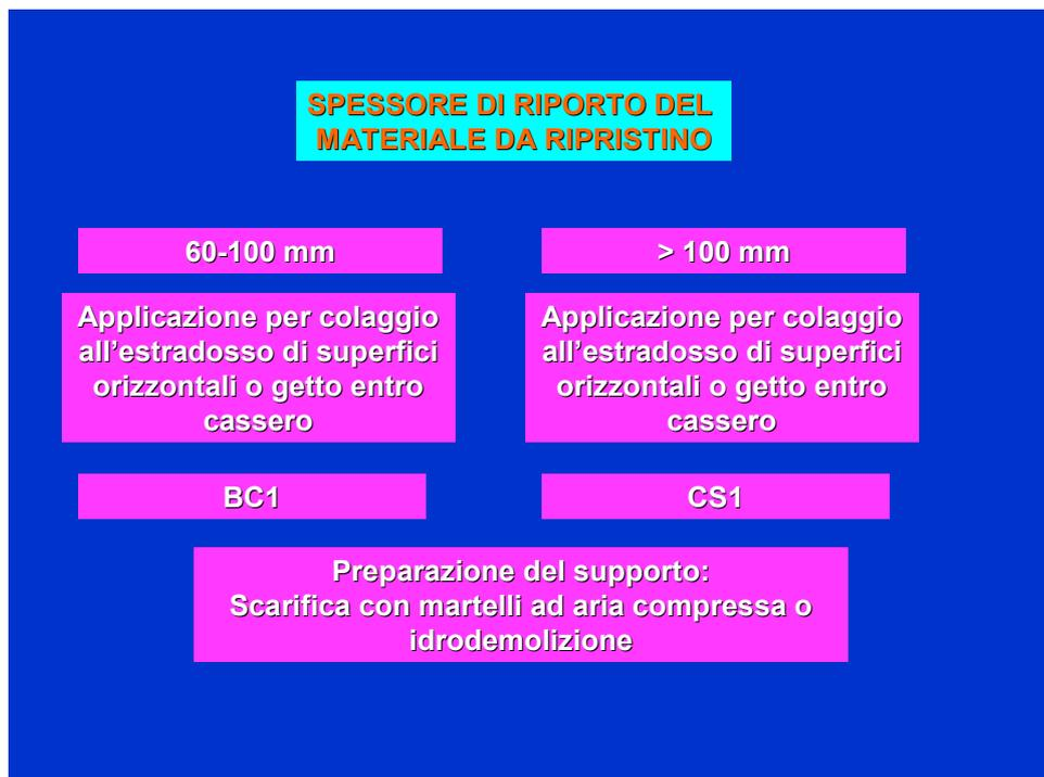
Nella Tabella che segue, quale ulteriore strumento di facilitazione nella scelta del tipo di malta / betoncino / calcestruzzo da utilizzare, si riporta un quadro sinottico che consente di definire la tipologia di prodotto di natura cementizia in base:
