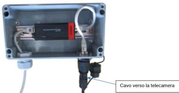
Figura 7: esempio di scatola di raccordo SR (con PoE+ Extender)
