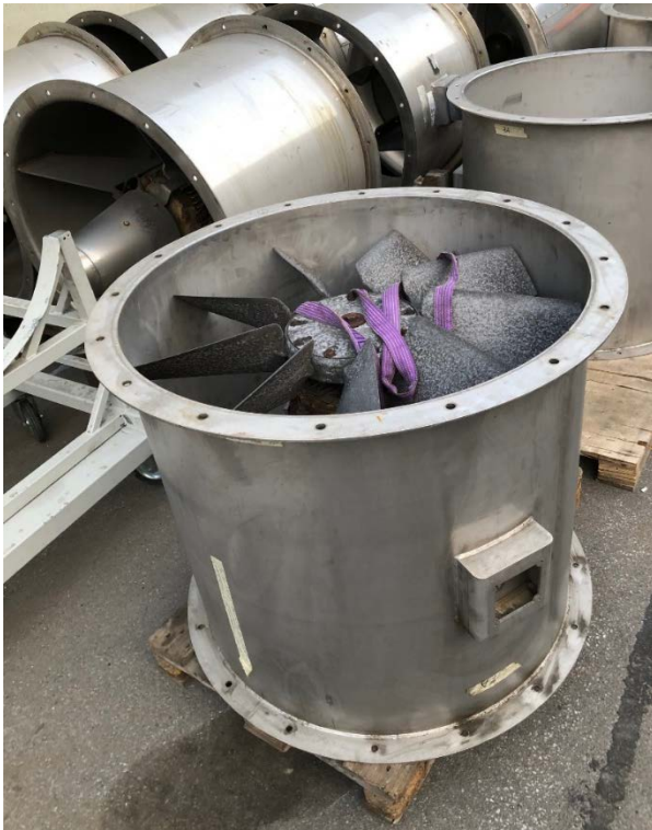
Immagine 1: ventilatore senza silenziatori, supporto e scatola di connessione:
