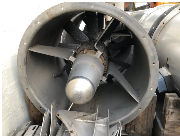
Immagine 2: motore installato con deflettore.
