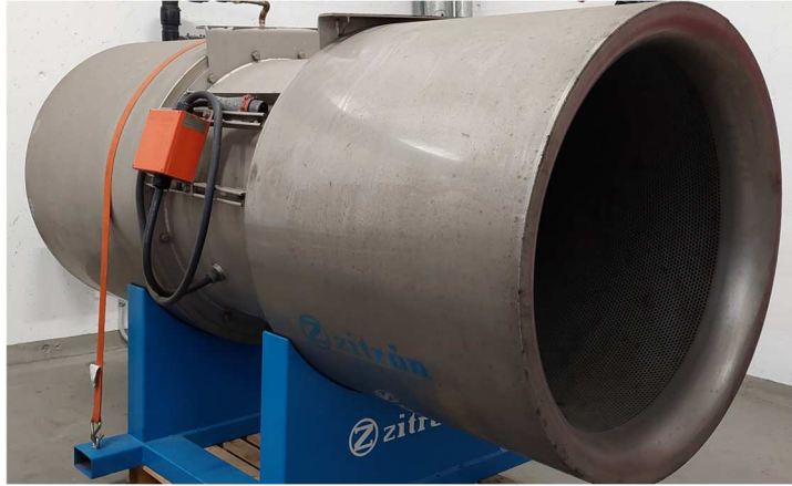
Figura 5: Ventilatore Zitron JZR 10-30/4 di riserva presso il portale lato Vedeggio
