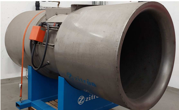
Figura 8: Ventilatore Zitron JZR 10-30/4 posizionati in calotta alla galleria
