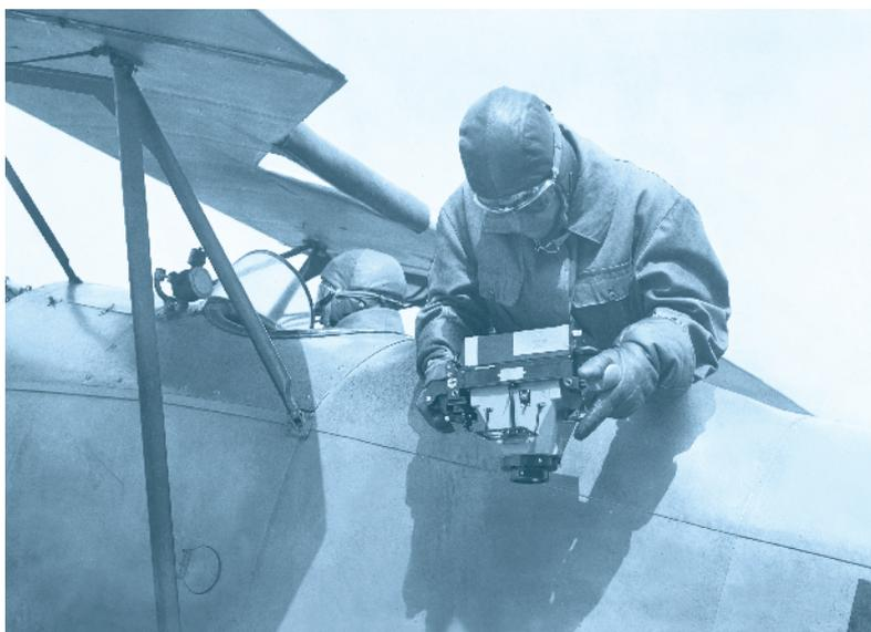
Il primo aereo di ricognizione del modello «Zepp» aveva un buco nella fusoliera per le riprese verticali. Le riprese oblique venivano effettuate da questo aereo aperto a mani libere e fuori bordo.
