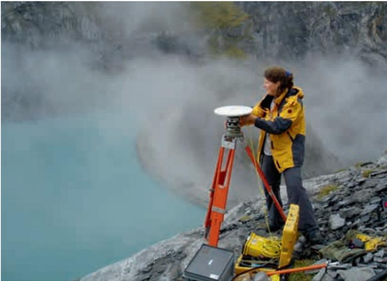
Misurazioni GPS ad alta precisione nella rete di base tridimensionale per la centrale di pompaggio-turbinaggio «Linthal2015» (GL).
