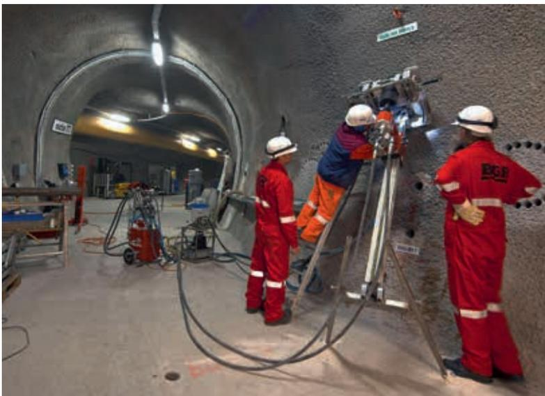
Ricercatori della Bundesanstalt für Geowissenschaften und Rohstoffe (BGR) durante l'esecuzione di una trivellazione presso il laboratorio sotterraneo del Mont Terri (JU) per l'ottenimento di campioni di argilla opalina.
