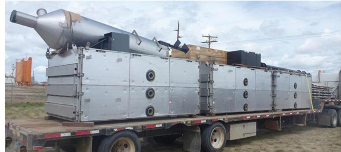
Un'unità portatile di trattamento termico a infrarossi per terreni contaminati da PFAS
