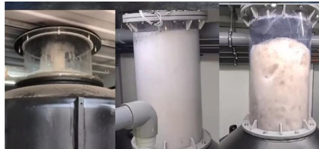
Schema di funzionamento e immagini di schiume di PFAS frazionate da acque/fanghi.
