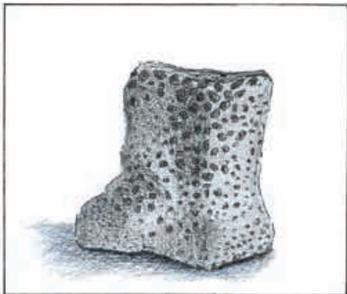
Che cos'è il vetro multicellulare? I pezzi di vetro vengono ridotti in frantumi e poi in polvere. In seguito viene aggiunto un additivo e messo in forno, dove il composto dapprima si fonde e poi si gonfia. La massa si raffredda in lastre e si riduce in pietrisco.
