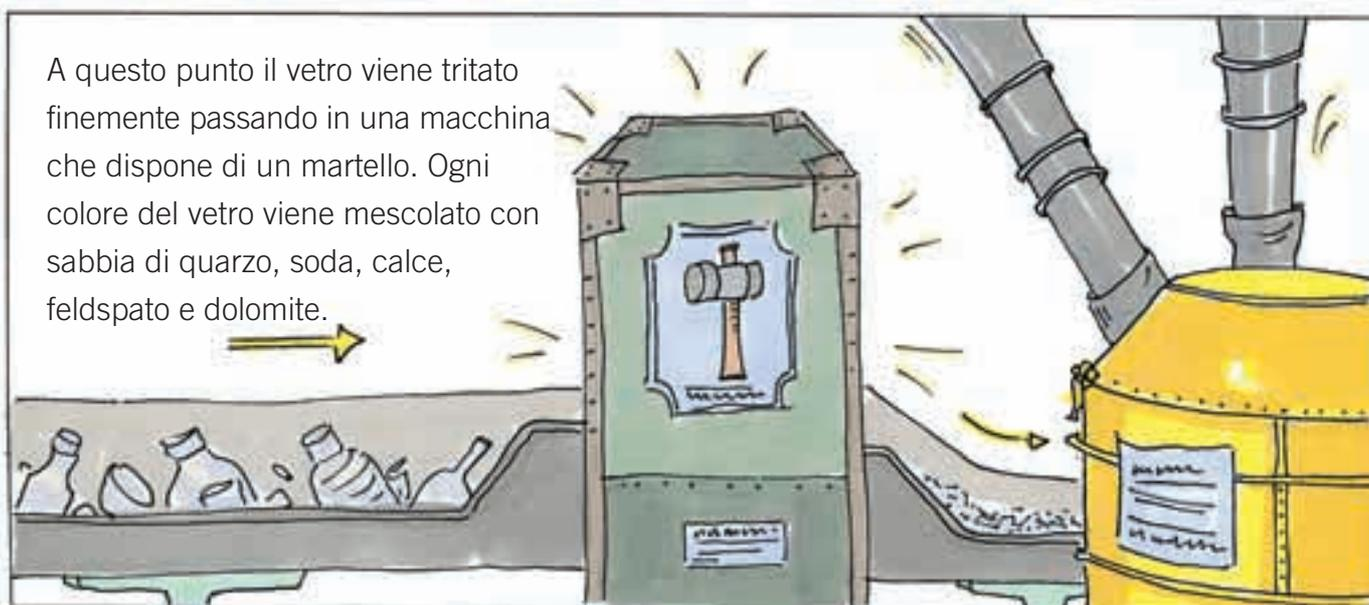
A questo punto il vetro viene tritato finemente passando in una macchina che dispone di un martello. Ogni colore del vetro viene mescolato con sabbia di quarzo, soda, calce, feldspato e dolomite.
