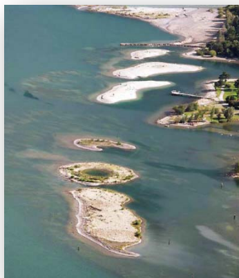
Figura 12 - Esempio di riporto a lago per la formazione di nuove isole nel lago di Uri (Fonte: www.reussdelta.ch ).
