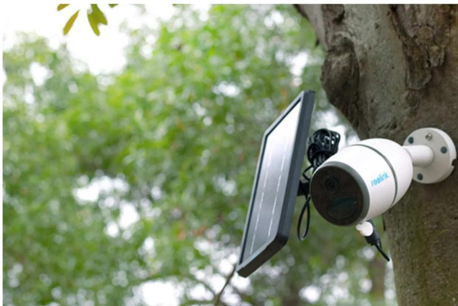
Una webcam per la sorveglianza piazzata su di un albero per migliorare la ricezione GSM e permettere il buon funzionamento di pannelli solari
