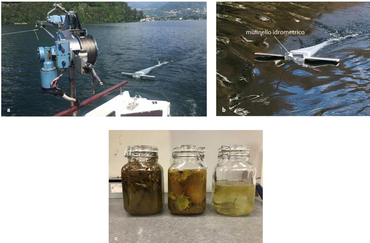
**Figura 2.2.1** a) Posizionamento della rete manta per il campionamento delle plastiche nelle acque superficiali; b) Attività di campionamento, il posizionamento di un mulinello idrometrico nella parte centrale della rete permette di misurare la superficie di lago filtrata; c) Esempi di campioni raccolti in tre diverse stagioni del 2020.
