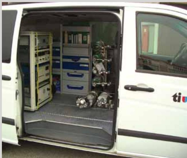
Furgone su cui sono montati gli apparecchi e le dotazioni necessarie ad eseguire le calibrazioni: bombole con concentrazioni di gas certificate dal fabbricante, il generatore d'ozono, un generatore d'aria zero.
