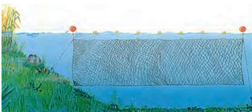
Fig. 14 – La rete da posta è simile alla rete volante, ma è ancorata al fondo ad una delle sue estremità (posa a bandiera) o ad entrambe.
