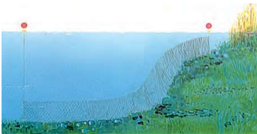
Fig. 15 – Le reti da fondo sono provviste di una corda piombata al piede e di una galleggiante in alto. La posa avviene direttamente sul fondale.
