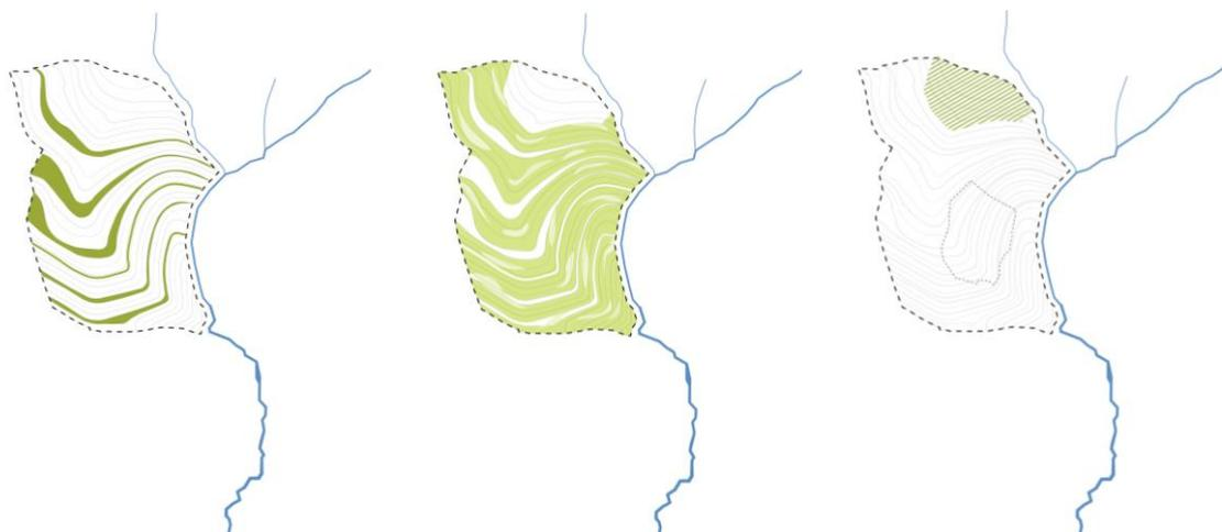
Figura 10. Concetto di sistemazione Variante 1: zone pianeggianti e berme (sinistra) pendii e radure (centro), ricollocamento della selva castanile (destra)
