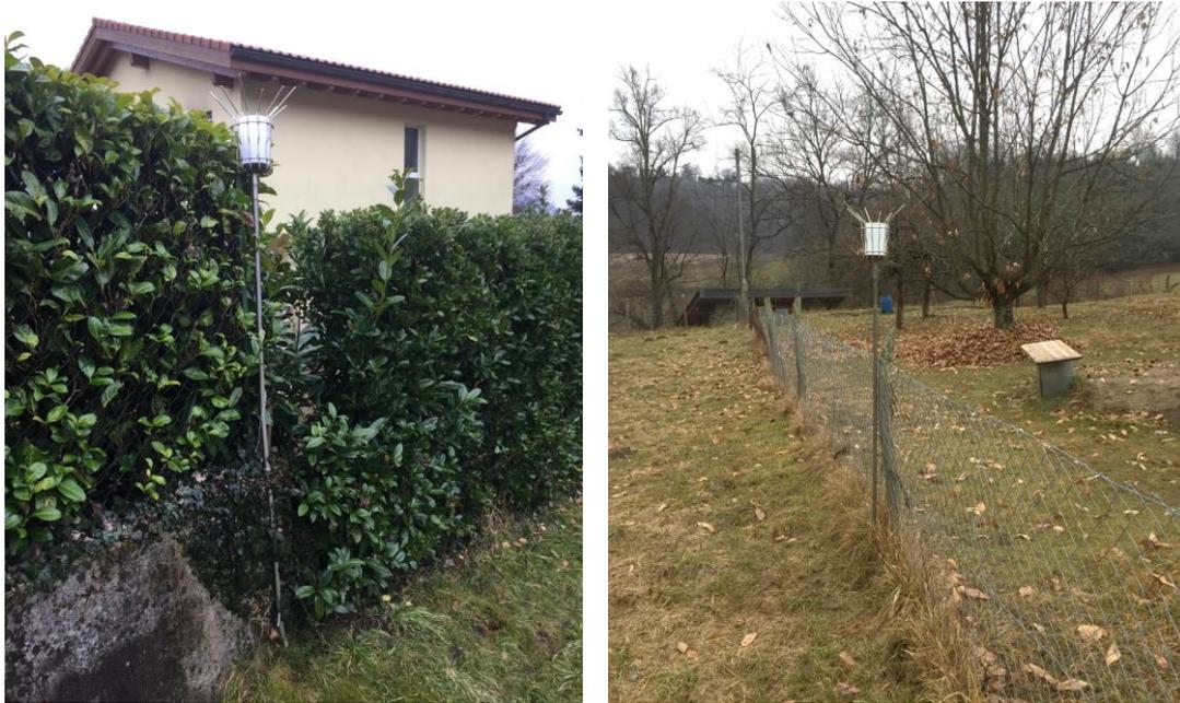
Figura 5-1: misuratori Bergerhoff esistenti e utilizzati per il monitoraggio delle attività della discarica *Fonderia 1*.
