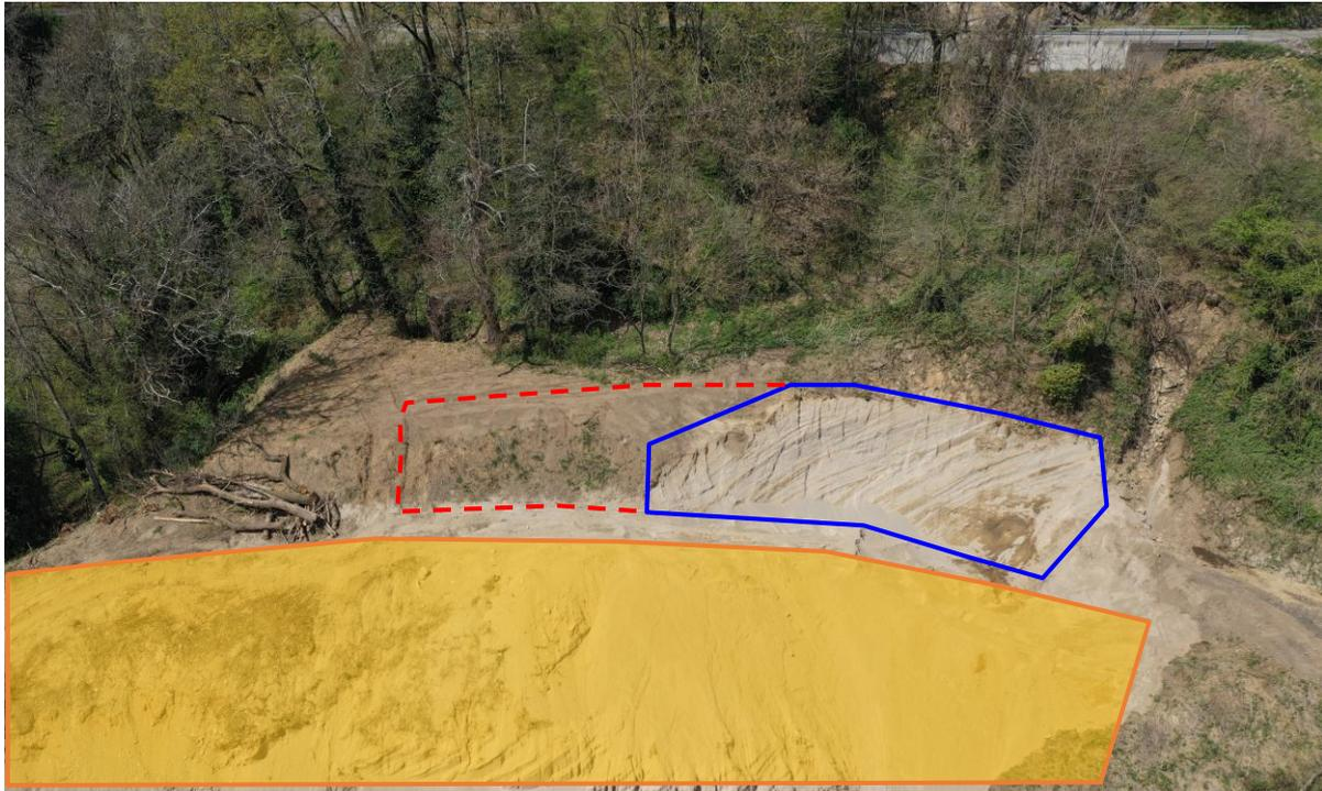
Figura 6-2: parete esistente (in blu) realizzata quale misura compensativa ai lavori di estrazione ed eventuale estensione (in rosso). In arancione è indicata l'area aperta e pianeggiante prevista sulla parte sommitale della futura discarica.
