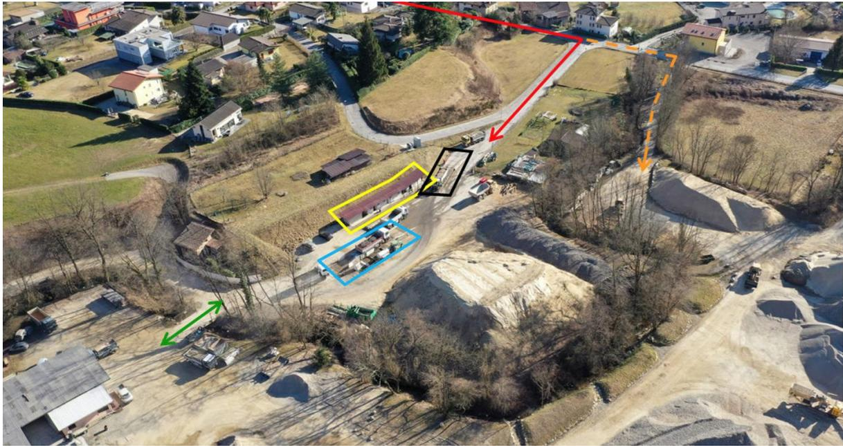
Figura 4-7: accessi e installazioni esistenti (vista da nord). In rosso: accesso principale; in arancione: accesso secondario; in verde: ponticello esistente; in nero: pesa; in azzurro: impianto lavaggio ruote; in giallo: baracche di cantiere.
