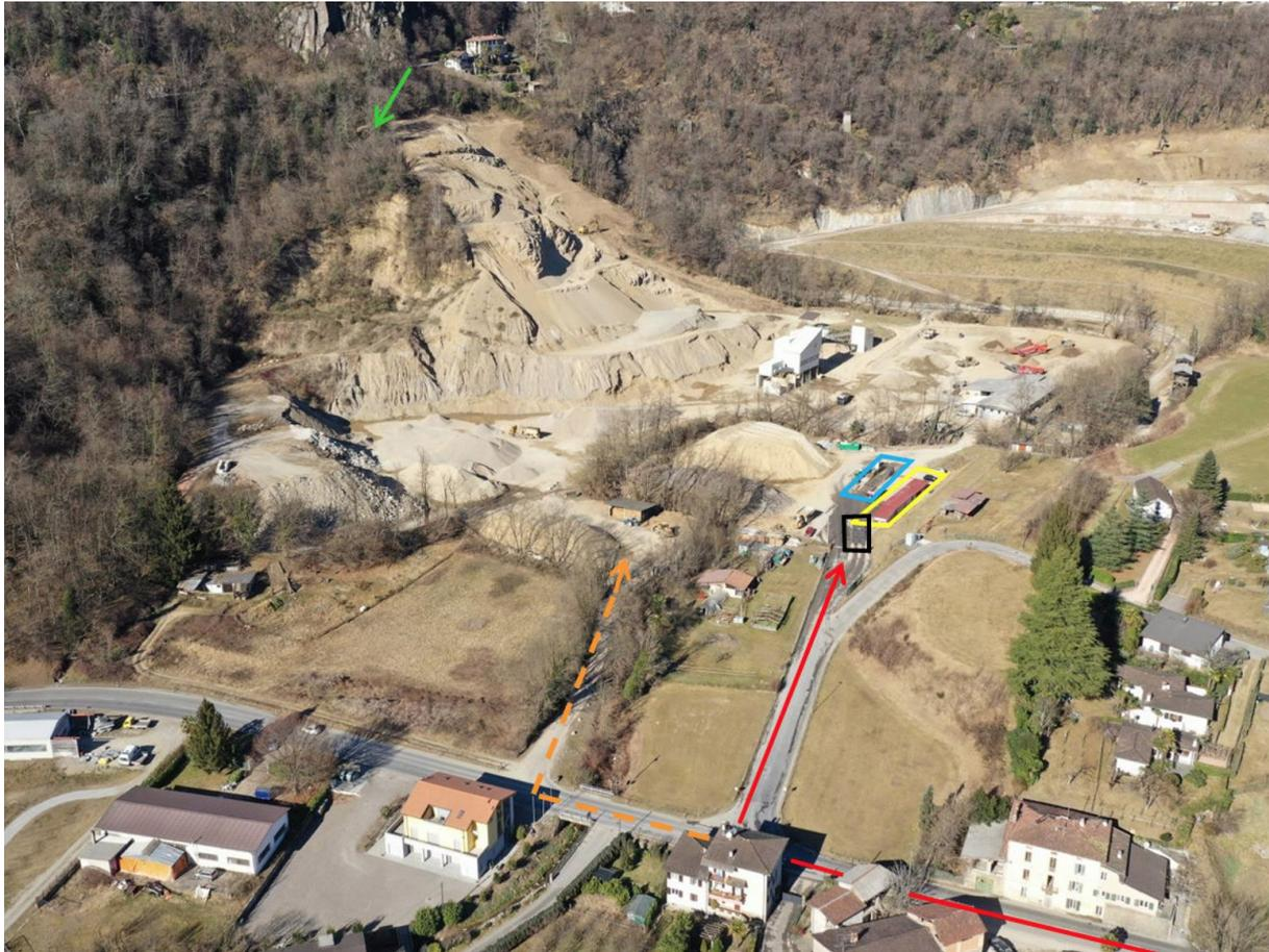
Figura 4-5: accessi all'area di progetto (vista da sud). In rosso: accesso principale; in arancione: accesso secondario; in verde: eventuale accesso supplementare per la manutenzione a lavori ultimati; in nero: pesa; in azzurro: impianto lavaggio ruote; in giallo: baracche di cantiere.
