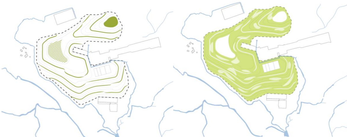
Figura 14. Concetto di sistemazione finale Variante 1: zone pianeggianti e berme (ricolloccamento di 6'440 m 2 di superficie agricola), a sinistra; pendii e radure, a destra.
