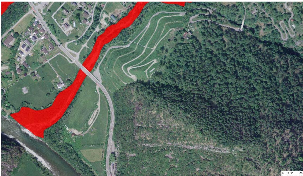
Figura 23: Carta dei pericoli naturali. In rosso: Erosione di sponda, grado di pericolo elevato.
