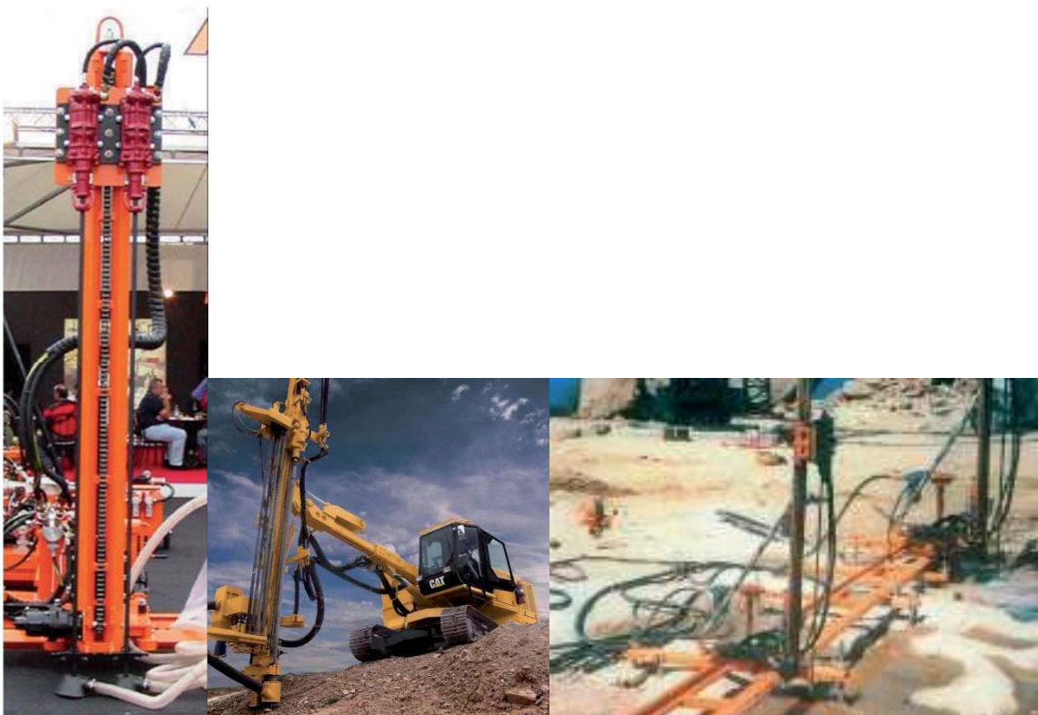
Immagine 4: Perforatore pneumatico su binario, cavalletto di perforazione montato su mezzo cingolato, perforatrice a slitta
