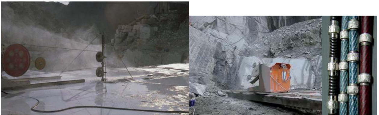
Immagine 7: Taglio al filo diamantato con l'utilizzo di pulegge, macchina, perline diamantate
