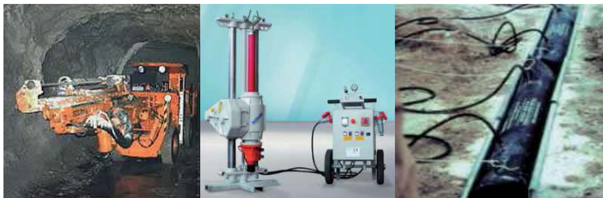
Immagine 12: Macchina perforatrice del tipo Jumbo, perforatrice elettrica ad avanzamento idraulico e hydro bag
