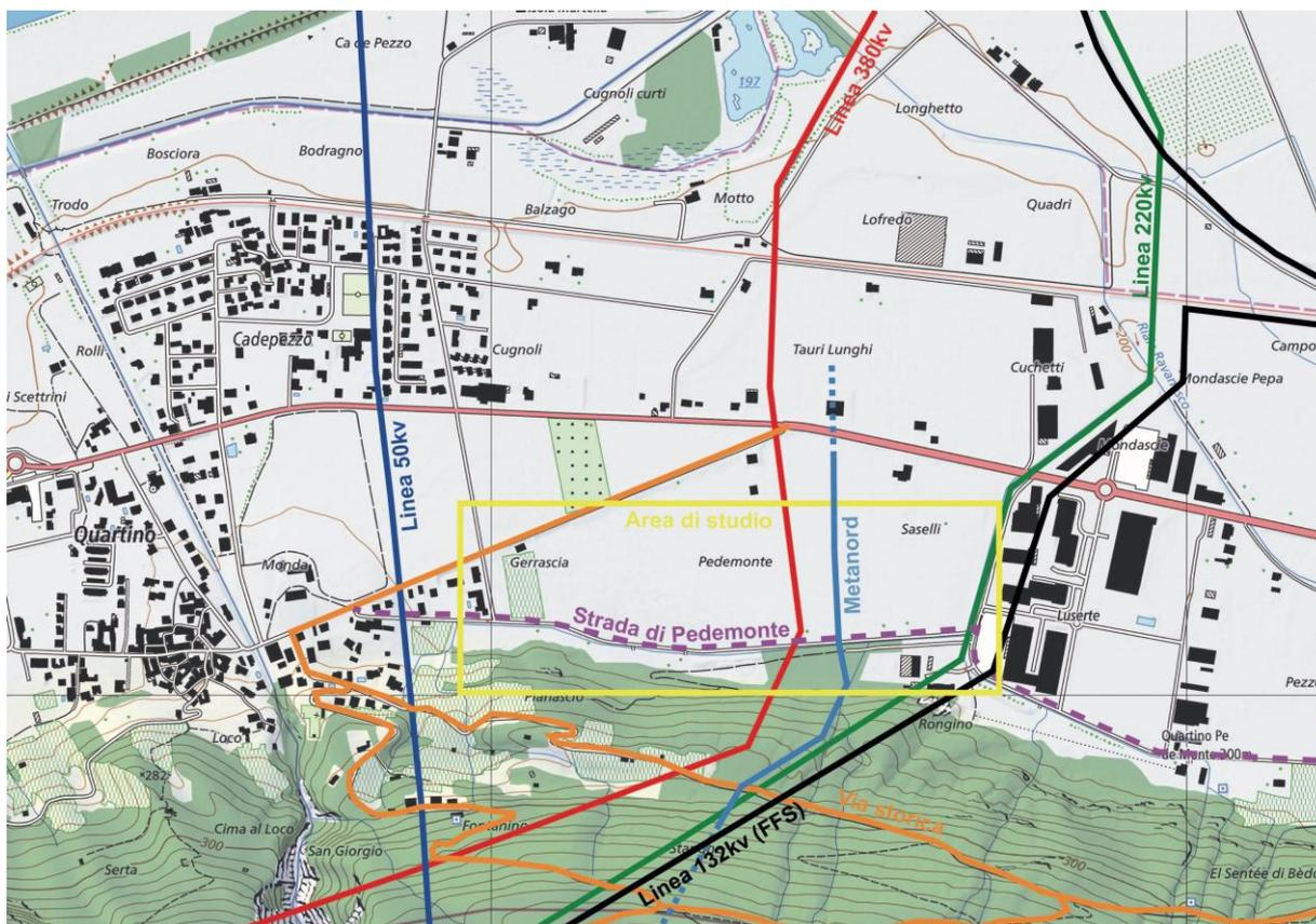
Figura 30: piano delle linee elettriche e altre infrastrutture: ad Ovest in blu la linea 50 kV che attraversa il paese di Quartino; in rosso la linea 380 kV; in verde la linea 220 kV e in nero la linea FFS 132 kV. In arancio la via storica; in viola la strada di Pedemonte; in giallo l'area di studio.
