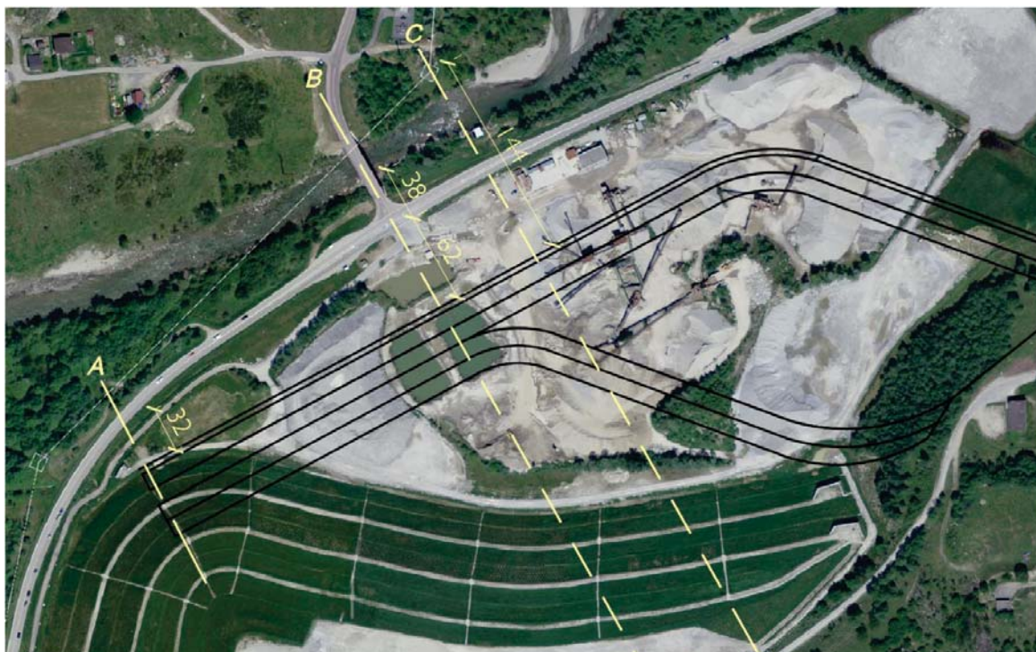
Figura 37 Sezioni determinanti per la verifica dei cedimenti
